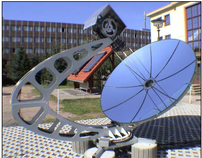
Bild 2 Solar-Stirling-Anlage mit Parabolspiegel, Stirlingmotor und mechanischer Konstruktion
