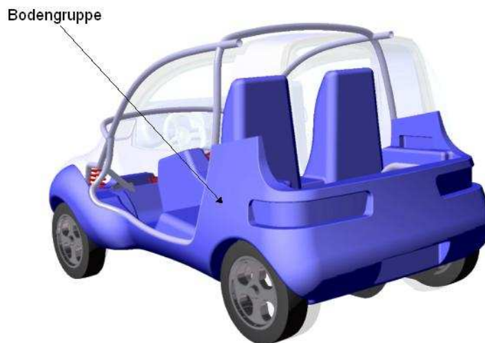
Abb. 3 Bodengruppe mit Sitzen, Mittelkonsole, Kofferraum und Fußraum
