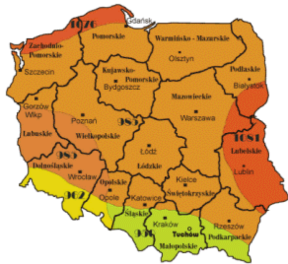
Bild 3. Die mittleren Jahreswerte der globalen Sonneneinstrahlung pro Einheit der senkrechten Oberfläche (in kWh/m 2 /a).
