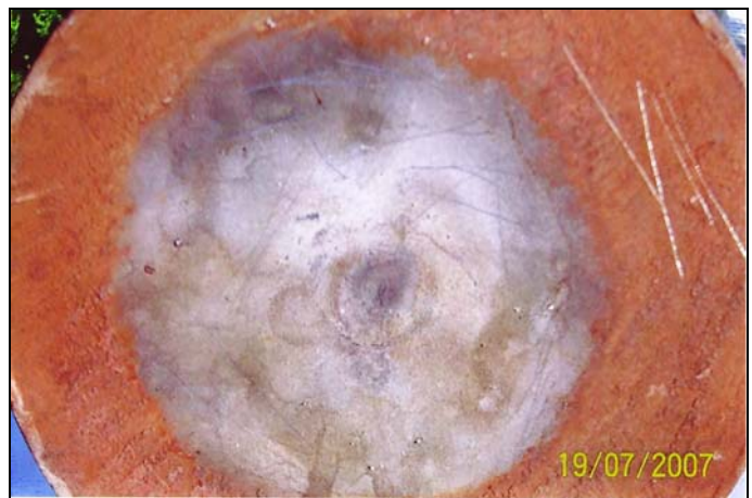
Bild 12 Verschleißerscheinungen im Absorber
